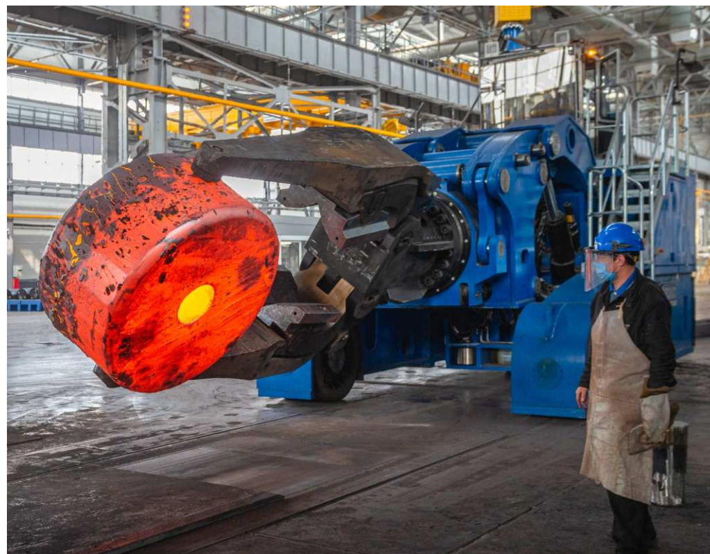
Поковки с прошивкой отверстия
