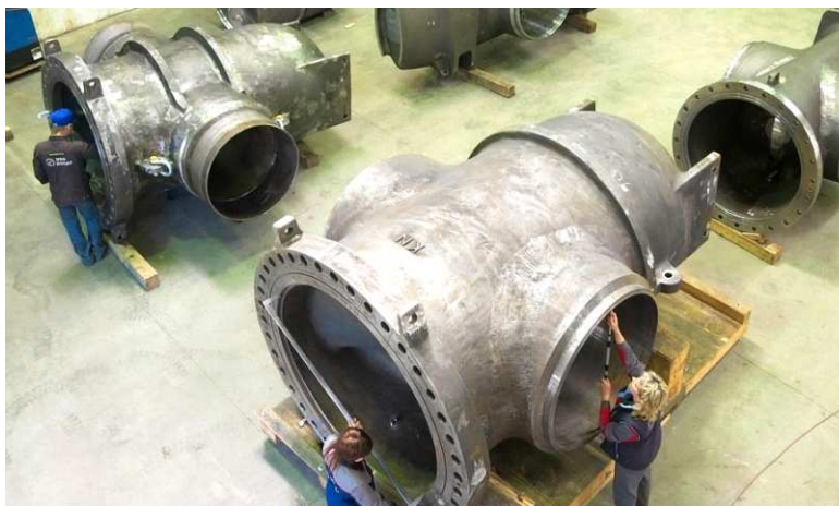
Отливки крупногабаритных корпусов насосов, ТПА весом до 30 тонн
