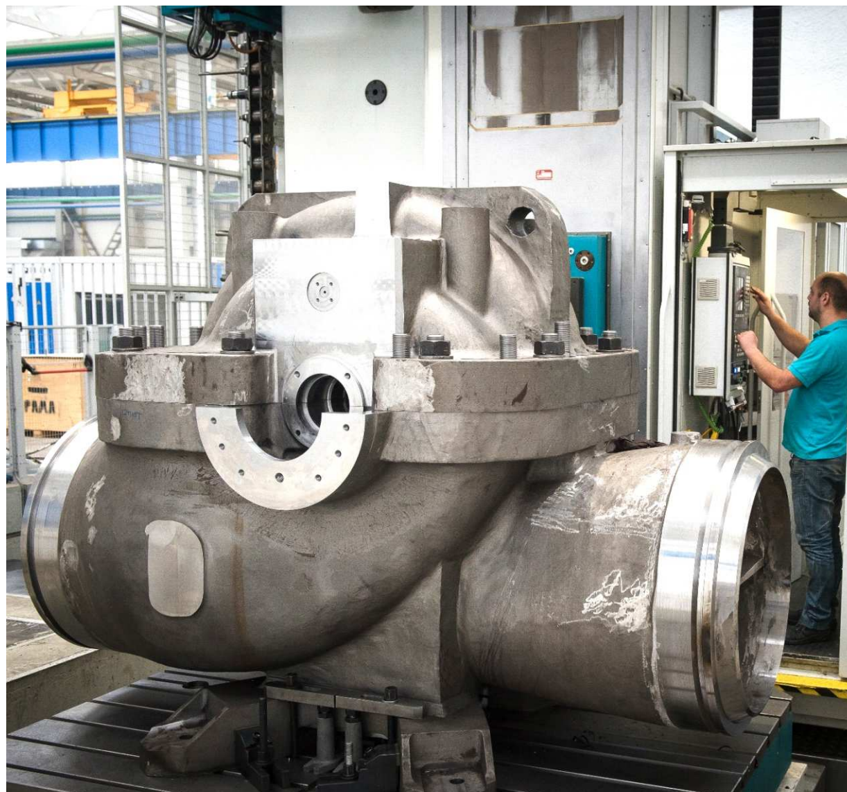
Механообработка корпуса насоса магистрального НМ 10000
