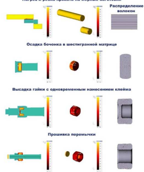
Горячая высадка поковки гайки на AMP 20/30 Нагрев и резка проката на мерные заготовки
