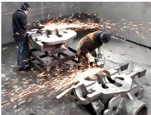
Отливки крупногабаритных корпусов насосов, ТПА весом до 30 тонн
