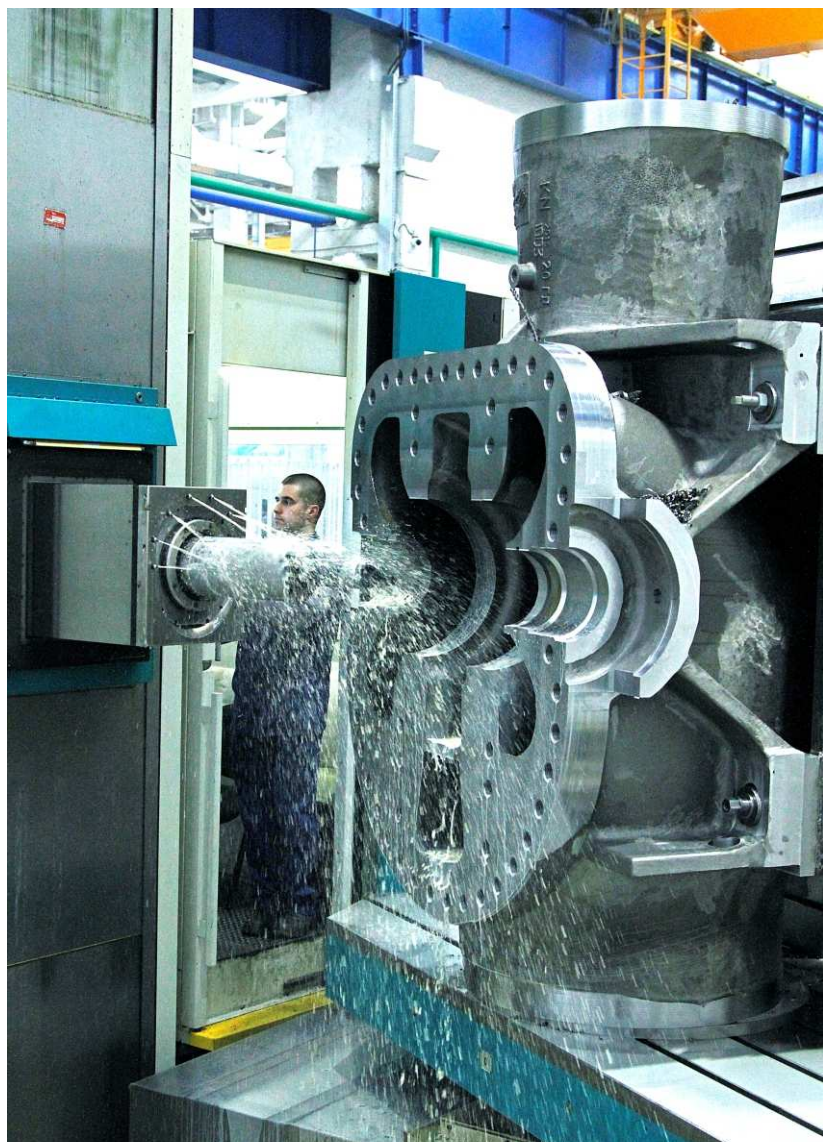
Механообработка крышки насоса магистрального НМ 10000
