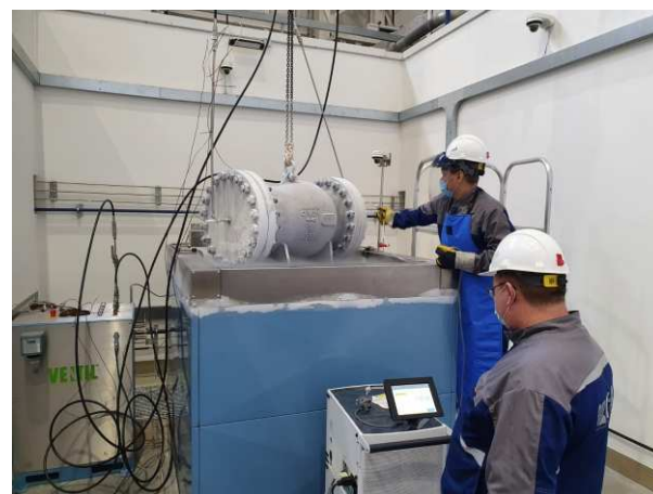
▲ Арктик СПГ2 ОГТ клапан обратный осевого потока по API6D RA 6"-16" 300RF CF8 36 штук;
