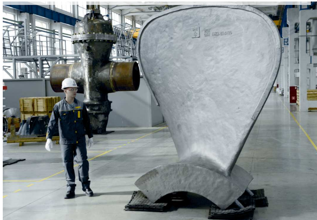
Лопасть арктического газовоза. Вес 10 тонн. Высота 2,5 м
