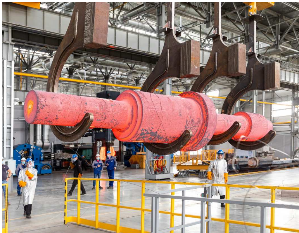
Ротор высокого давления паровой турбины
